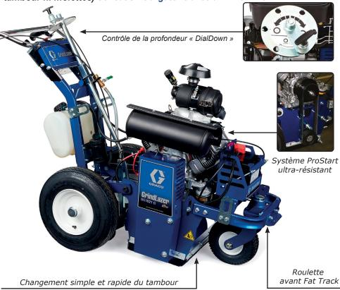
La GrindLazer HP DC1021 G est un rabot routier très haute-performance pour effacer les lignes de parkings et le marquage routier. Retrait de peinture de signalisation, produits thermoplastiques, revêtement époxy, lissage des surfaces irrégulières, rainurage.
